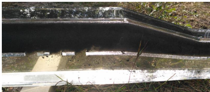
Ryc.18. Przepływ hydromieszanki przez separator: góra przenoszone są osady organiczne i drobne frakcje mineralne, przez szczeliny opadają większe cząstki.
