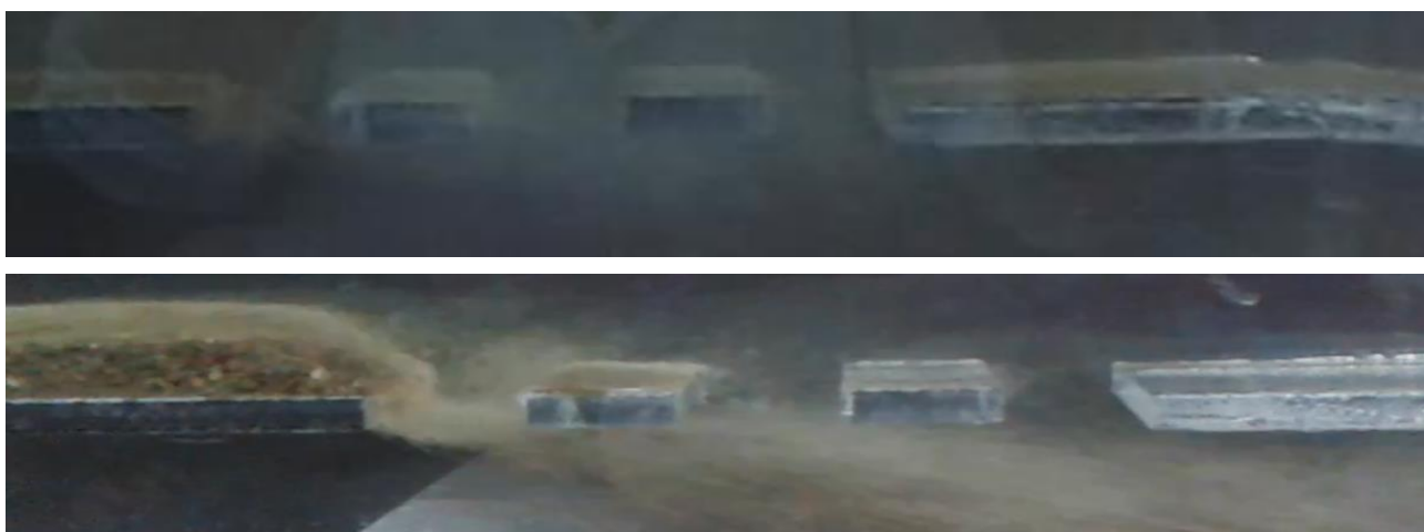
Ryc. 10. Separacja hydrauliczna osadów pobranych z dna zbiornika: frakcje drobne transportowane są jako rumowisko unoszone ponad szczelinami, frakcje grube jako rumowisko wleczone przepływają przez szczeliny.
