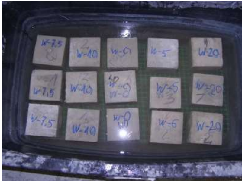
Rycina 20. Próbkki betonowe 100x100x100mm w trakcie nasączenia wodą
