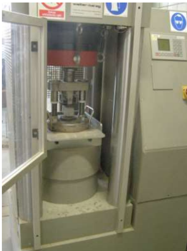
Rycina 11. Prasa Walter + Baig z nakładką do ściskania próbek z zaprawy normowej
