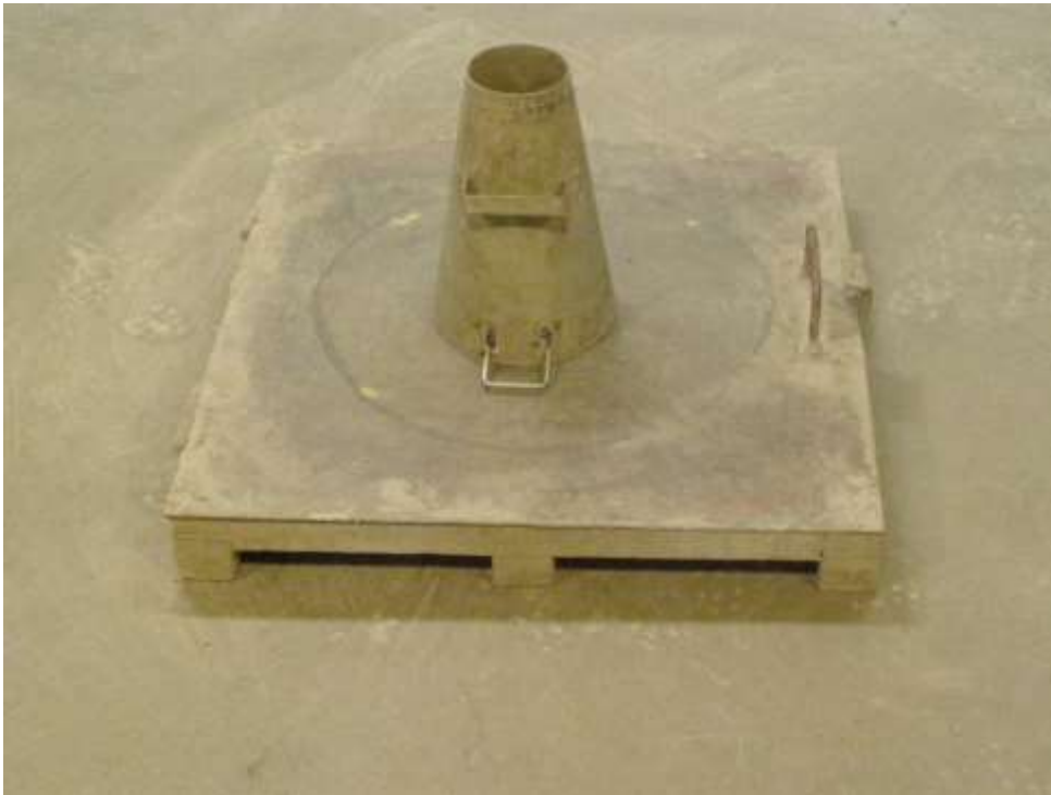
Rycina 17. Stożek Abramsa umieszczony na stoliku wstrząsowym
