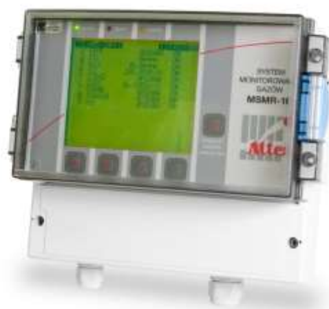
Rycina 5. Aparatura monitorująca stężenie H 2 S i CO 2 w obiekcie badawczym
