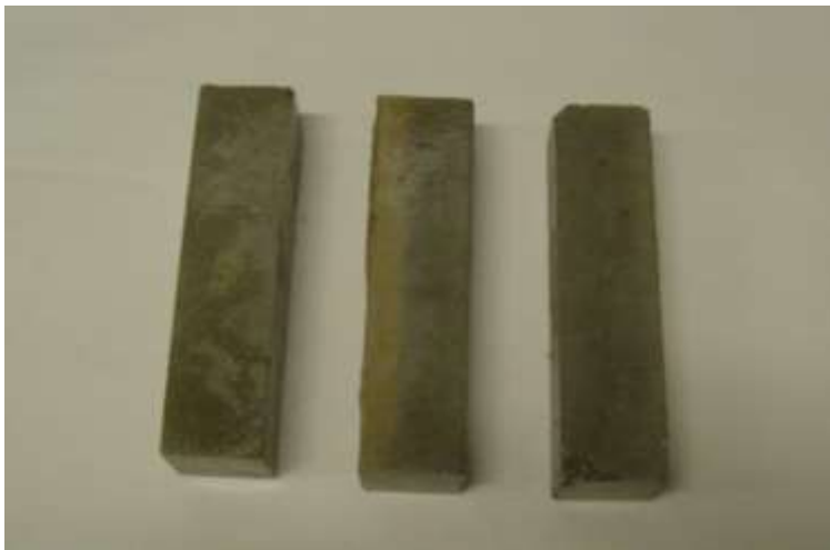
Rycina 10. Próbki 4x4x16 cm z zaprawy normowej
