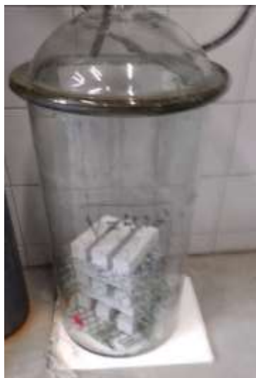
Rycina 23. Eksykator z umieszczonymi wewnątrz próbkami
