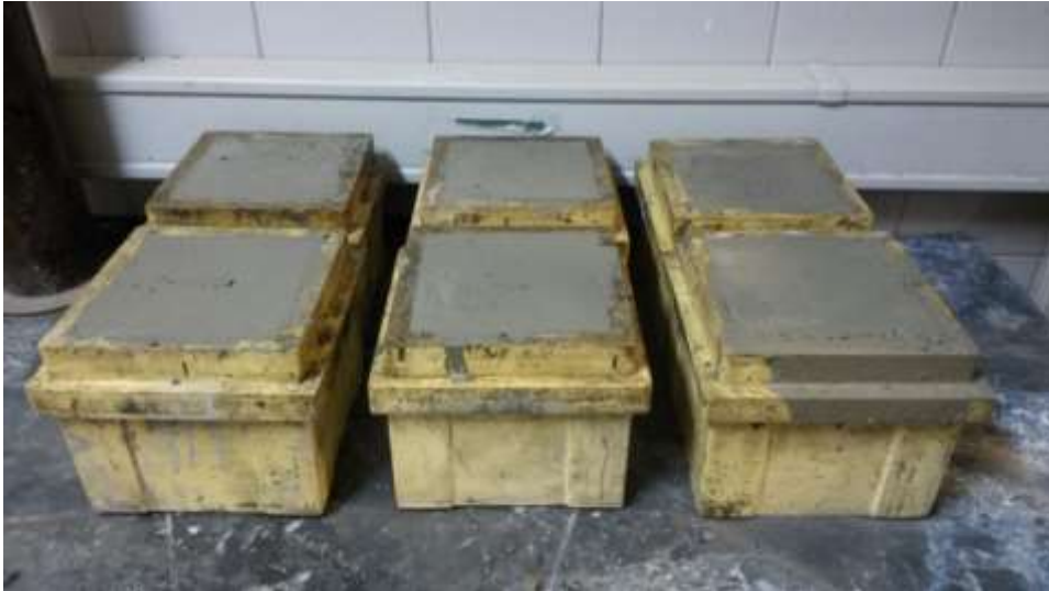
Rycina 15. Przykładowa, zaformowana seria próbek o wymiarach 150x150x150 mm
