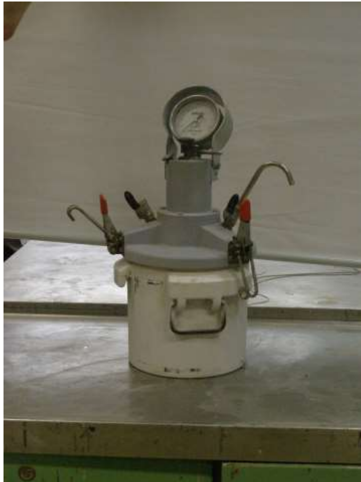
Rycina 16. Przyrząd do badania zawartości powietrza metodą ciśnieniową
