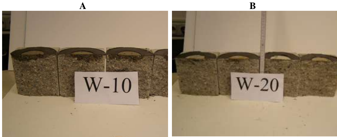
Rycina 28. Próbki serii W-20 (A) i W-20 (B) po rozłupaniu
