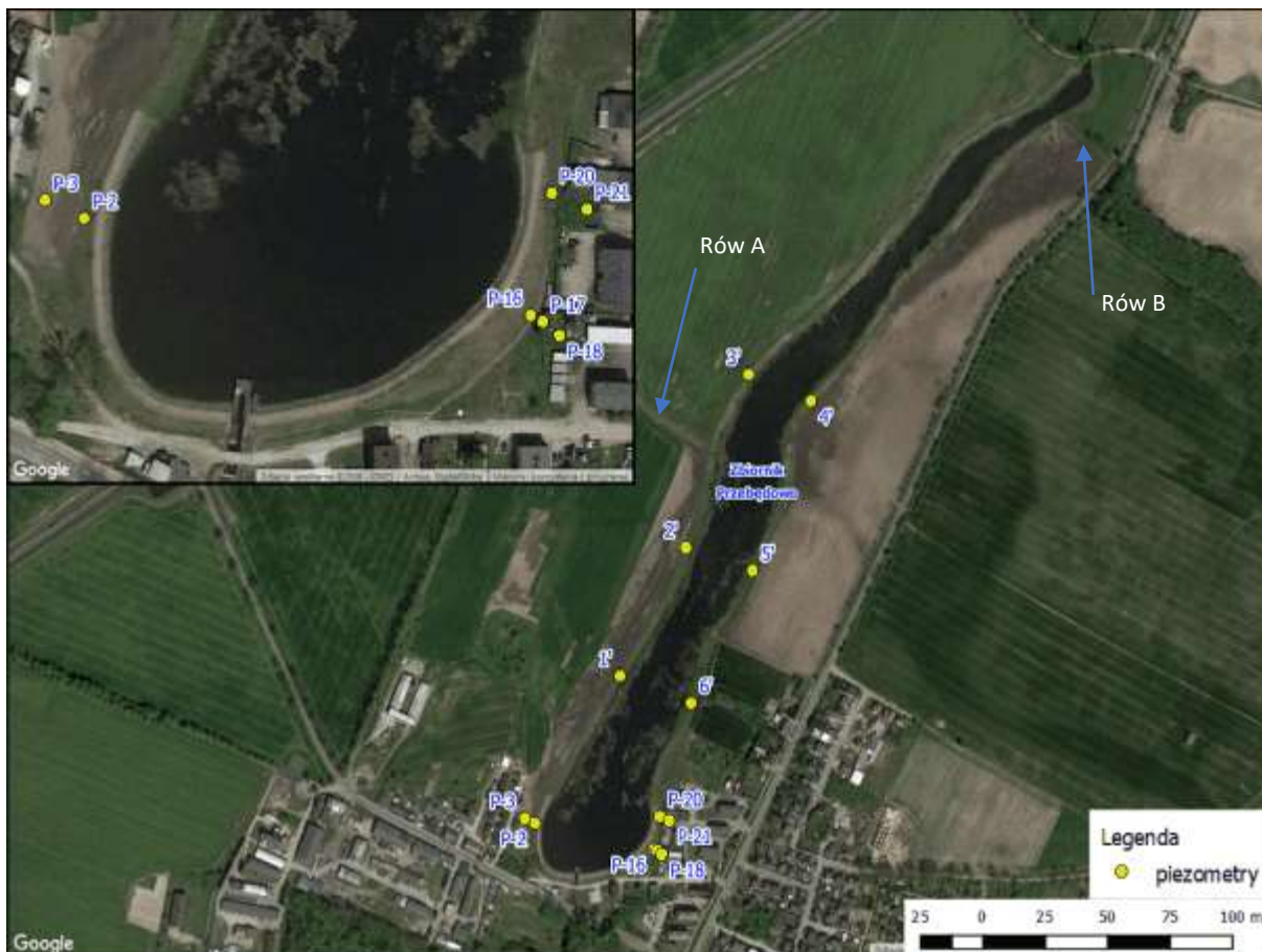
Ryc.6. Lokalizacja studzienek do pomiaru stanów wód gruntowych w terenie przyległym do zbiornika (źródło: Waligórski i in. 2020)
